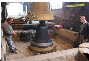
26 avril 2021 Le démoulage
